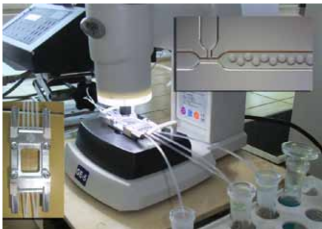
Prikaz eksperimentalne opreme za tvorbo mikroemulzij v laboratoriju za mikroprocesno inženirstvo
